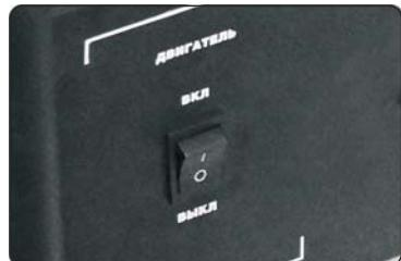
(c) Установите выключатель в положение «ВЫКЛ».
