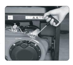
(f) После запуска двигателя, плавно верните рычаг дроссельной заслонки в положение «ОТКРЫТО» (при запуске от ручного стартера).
