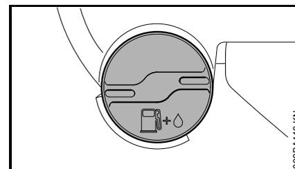
Винтовое запорное устройство бака
