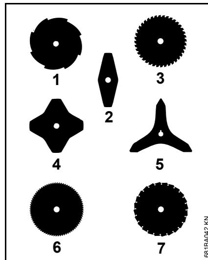
Для режущих полотен для травы 230-2 (2), 230-4 (4), 230-8 (1), 250-40 Spezial (3) и ножа для молодняка (5) на защите косильного инструмента не требуются такие
