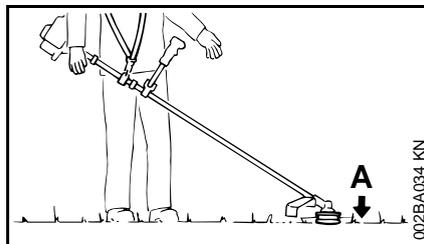
Косильные инструменты (A), такие как косильные головки, режущие полотна для травы и ножи для молодняка
