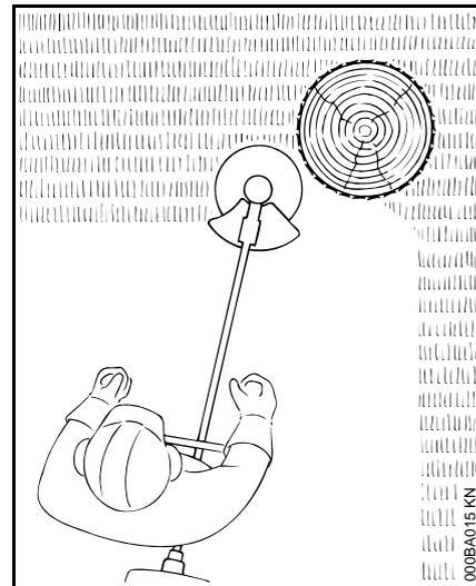
Для мягкой "резки" – для чистой резки также краёв с трещинами вокруг деревьев, столбов для изгороди – кора деревьев повреждается в меньшей степени.
