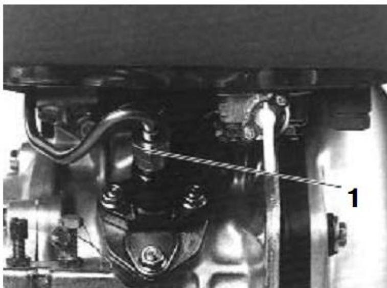
*1- Гайка трубопровода высокого давления*
