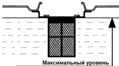
Рис. 5 Максимальный уровень топлива в топливном баке
