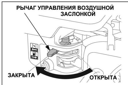
Рис. 17 Рычаг управления воздушной заслонкой
