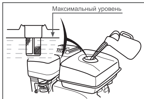
Рис. 8 Максимальный уровень топлива в топливном баке
